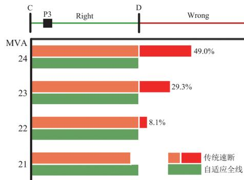
图 14 三相短路时自适应全线电流保护与传统电流速断保护的保护区
