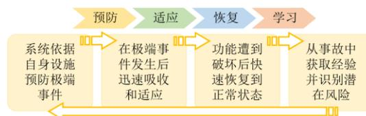
图2 电力系统韧性研究框架
