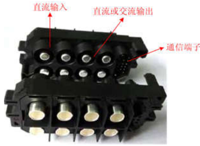
图13 强弱电一体化即插即用连接器
