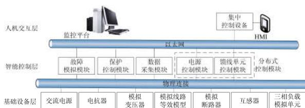
图 1 配电网物理模拟系统结构图
