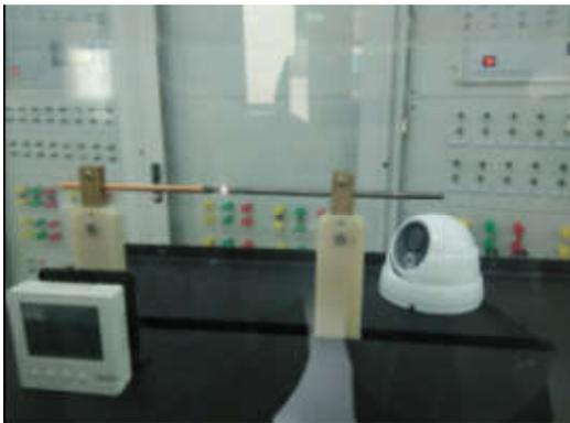
图 16 实物模型 A 相弧光接地故障
