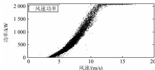
图1 风电功率散点图
