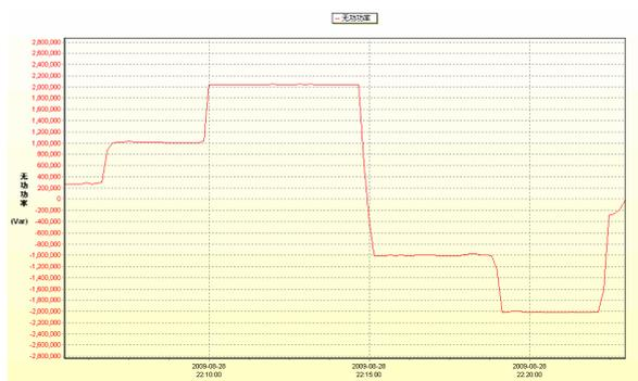
图 7 D-STATCOM 输出无功曲线
