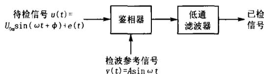
图 2 相关检波原理
