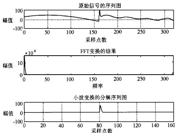
图1 故障暂态信号的 FFT 变换和小波变换
