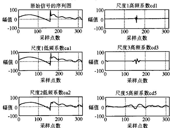
图2 故障信号的多尺度分析
