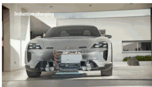
图 5 保时捷 MISSION E 配置的 EV WPT 系统
