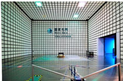
(a) 十米法半电波暗室
