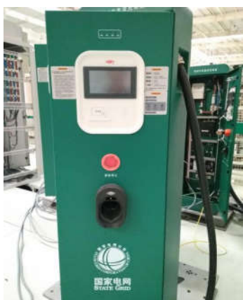
图 11 直流充电桩 Fig. 11 DC charging pile
