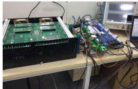
图 4 基于 eHS 永磁直驱风机硬件在环仿真平台实物图
